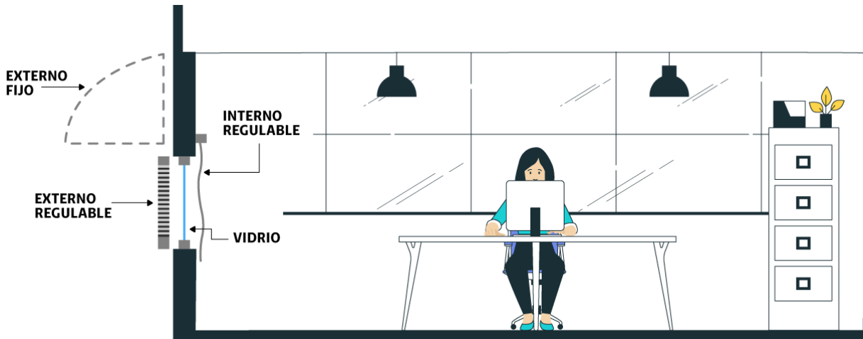
Figura 3.2.1.7. a. Ejemplo de dispositivos para controlar el ingreso de la luz diurna. (Fuente propia)
